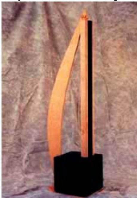
**Platinum IV Ribbon Driver** — новая модель ленточного дипольного излучателя фирмы Carver. Излучатель работает с частоты 200 Гц. В нем используется алюминиевая пленка толщиной 10 мкм, скрепленная по особой технологии с тонкой (12 мкм) пленкой из каптона (особо прочный
