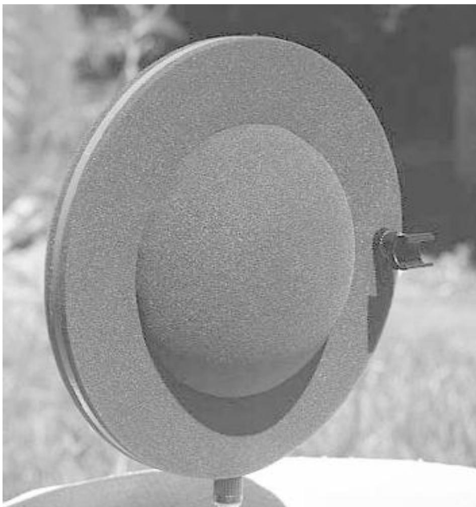
Разновидностью экранной системы является сферический микрофон — два микрофонных капсюля устанавливаются заподлицо по бокам твердой сферы диаметром 20 см. Сферический микрофон изобрел инженер Guenther Theile из IRT (Institut für Rundfunktechnik — немецкий радиотехнический институт), поэтому его часто называют **Theile Sphere**. Практическим воплощением этой идеи является модель Schoeps KFM6.
